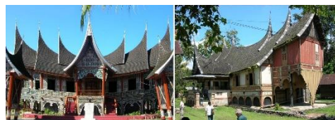
Gambar 9. Rumah Gadang , Sumatera Barat memiliki deretan (dari tengah ke samping kiri dan kanan) kolom yang semakin miring.
