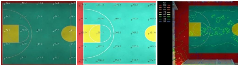
Gambar 8. Gambar intensitas cahaya pada area lapangan sisi utara (awal, simulasi dan kountur)
